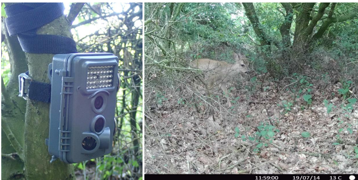
Abb. 10: Wildtierkameras (links) werden zur Erfassung von Säugetieren eingesetzt. Mit Hilfe eines Bewegungssensors löst das Annähern eines Tieres ein Foto aus, hier am Beispiel eines Rehs (rechts). Diese Methode kann auch bei Nacht genutzt werden.
